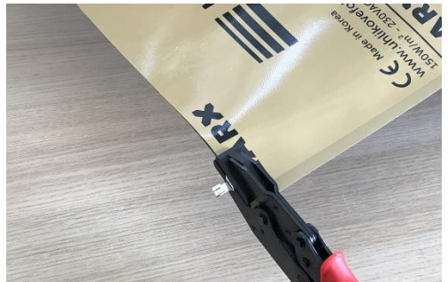
Verpressen des Steckers mit einer
