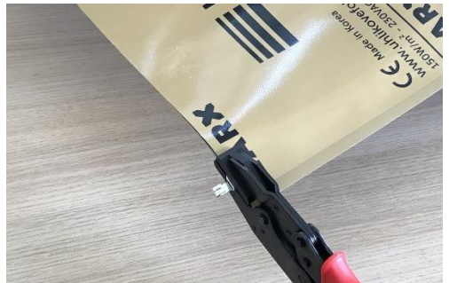
Verpressen des Steckers mit einer
