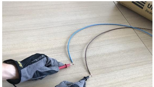
Messung des elektrischen Widerstands
